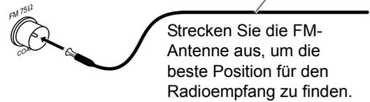
Strecken Sie die FM-Antenne aus, um die beste Position für den Radioempfang zu finden.
