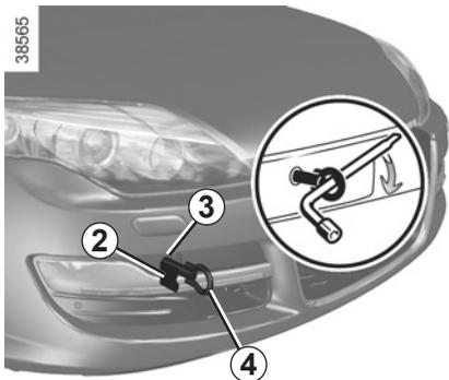
Utilisez exclusivement les points de remorquage avant 3 et arrière 5 (jamais les tubes de transmission ou toute autre partie du véhicule). Ces points de remorquage ne peuvent être utilisés qu'en traction, en aucun cas ils ne doivent servir pour soulever directement ou indirectement le véhicule.
