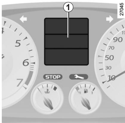
Cette fonction, intégrée à l'ordinateur de bord **1**, permet l'activation/désactivation et le réglage de certaines fonctions du véhicule.
