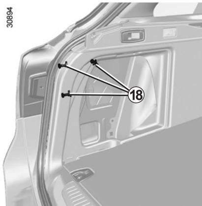
De l'intérieur, desserrez les trois vis **18** puis, de l'extérieur, dégagez le bloc feu en le tirant vers l'arrière puis déclipsez le porte-lampe.
