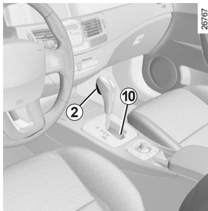
**À la mise en route**, dans le cas où le levier est bloqué sur **P** alors que vous appuyez sur la pédale de frein et sur le bouton de déverrouillage **2**, il y a possibilité de libérer manuellement le levier. Pour cela, appuyez en passant un objet dans le trou **10** et appuyez simultanément sur le bouton de déverrouillage **2** situé sur le levier.
