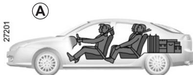
Placez toujours les objets transportés de façon à ce que leur plus grande dimension soit en appui contre le dossier de la banquette arrière, ce qui est le cas pour les chargements usuels (exemple **A**) ou contre les dossiers des sièges avant lorsque les dossiers de la banquette arrière sont rabattus.
