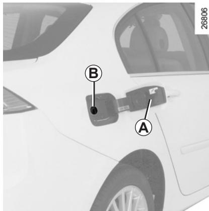
Le clapet **B** est intégré au conduit de remplissage.
