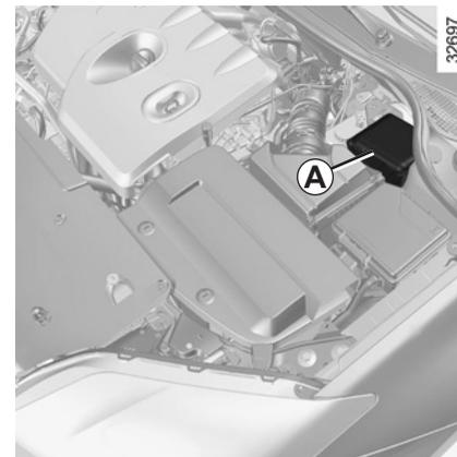
Certains accessoires sont protégés par les fusibles situés dans le compartiment moteur dans le boîtier A.
