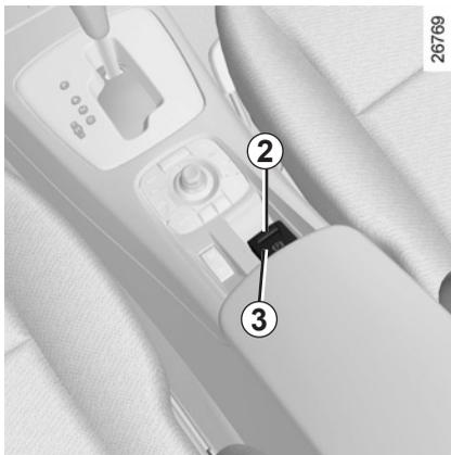
Le serrage du frein de parking assisté est confirmé par le message « Frein de parking serré » et le témoin (P) au tableau de bord et par l'allumage du témoin 2 sur le contacteur 3.
