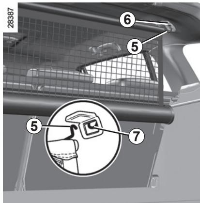
Sortez la tringle **5** de son logement et introduisez-la dans les points d'ancrage **6** (**impérativement dans l'anneau 7**).
