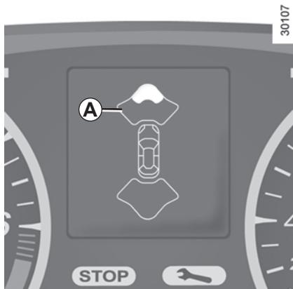
Dans le cas où un obstacle est présent à l'avant et à l'arrière du véhicule, seul le plus proche sera pris en compte et le signal sonore correspondant se fera entendre. Si un obstacle est détecté à la fois à l'avant et à l'arrière dans une zone de détection inférieure à 30 centimètres, alors des signaux sonores avant et arrière retentiront alternativement.
