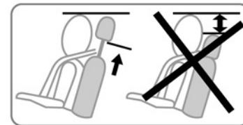
Les trois crans supérieurs peuvent être manipulés sans appui sur le bouton **2**. Cependant, il est préférable d'appuyer sur ce bouton pour descendre l'appui-tête.
