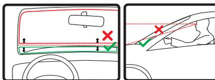
Vous pouvez fixer le socle sur le pare-brise ou une vitre latérale ou encore sur le tableau de bord à l'aide d'un disque de fixation. TomTom propose également d'autres solutions de fixation pour votre appareil de navigation TomTom. Pour de plus amples informations sur les disques de fixation pour tableau de bord et les autres solutions de fixation, rendez-vous sur [www.tomtom.com/accessories](http://www.tomtom.com/accessories).
