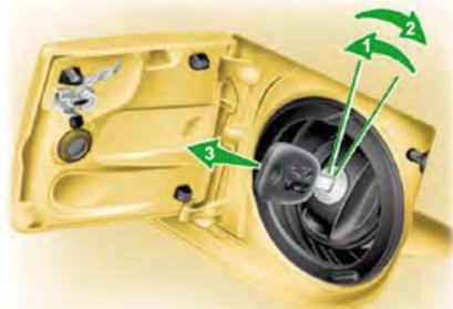
Après avoir ouvert la trappe, introduisez la clé puis tournez légèrement vers la gauche et ensuite revenez vers la droite. La clé revient dans sa position initiale et le bouchon est déverrouillé.
