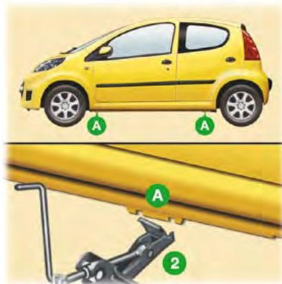
3. Placez le cric 2 en contact avec l'un des quatre emplacements A prévus sur le soubassement, le plus proche de la roue à changer.
