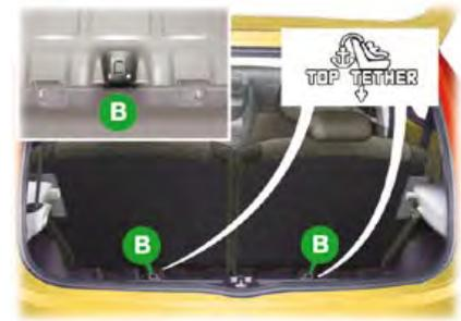
Les **sièges enfants ISOFIX** sont équipés de deux verrous et/ou d'une sangle qui viennent facilement s'ancrer sur ces anneaux, signalés par des étiquettes ou par un marquage sur la tôle du dossier arrière.
