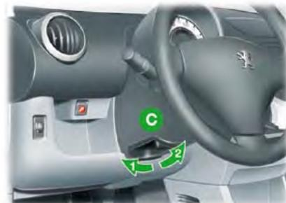
**C.** Commande de verrouillage et de déverrouillage du réglage en hauteur du volant.
