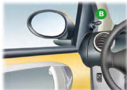
**B.** Commande de réglage des rétroviseurs extérieurs.
