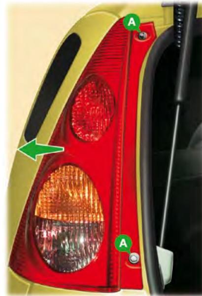
Ces 3 lampes se changent par dépose du feu :
