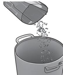
**2. Tolumahuti tühjendamine.** Eemaldage filtrid ning tühjendage sisu prügikasti. Paigaldage filtrid ning klōpsake tolumahuti oma kohale.
