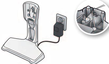
**1. Asetage laadimisjaam kuumaallikatest, otsesest pääkesevalgusest ja niisketest kohtadest eemale. Sisestage adapter elektrikontakti ja ühendage see laadimisjaama.**
