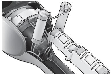
2. **Atvienojiet pievenotos kabelus,** izņemiet barošanas elementu un virs redzamajām metāla daļām uzlieciet lenti. levietojiet barošanas elementus piemērotā iepakojumā.
