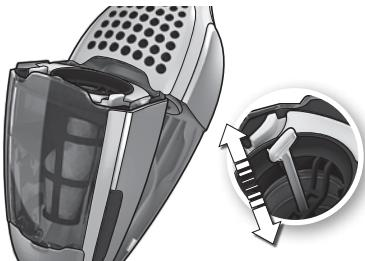
**3. Hitro čiščenje filtra za drobne delce** (priporočljivo ob vsakem čiščenju). Odstranite zbiralnik za prah, pet- ali šestkrat povlecite in spustite vzmet, da odstranite prah.
