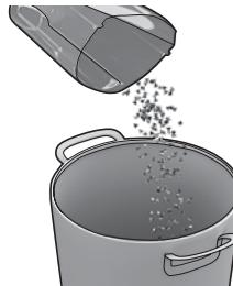
**1. Hitro praznjenje zbiralnika za prah.** Odprite pokrov sesalnika. Očistite zbiralnik za prah, tako da v odprtino vstavite cev drugega sesalnika in prah posesate.
