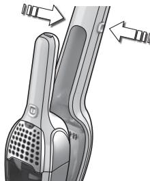
**1. Выньте ручной блок, нажав кнопку-фиксатор.** Щелевая насадка и малая щетка хранятся в зарядном устройстве.
