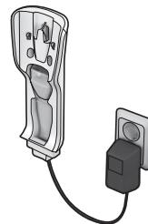
**3. Кроме того,** на стену можно установить настенный блок. Отделите его от напольного блока. Убедитесь, что стена может выдержать вес пылесоса Ergorapido.
