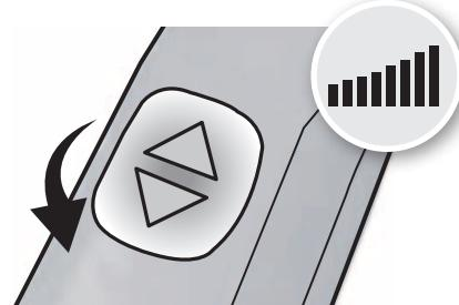
**3. Nastavite stopnjo moči s pritiskom spodnjega dela tipke za vklop/izklop.**
