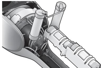
1. Разрядите батареи перед извлечением. **Перед извлечением батарей пылесос Ergorapido необходимо отключить от зарядного устройства.** Отверните винты. Осторожно снимите крышку.
