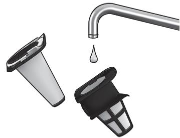
**4b. Ločite filtra.** Zbiralnik za prah in filtra lahko odresetete ali pa jih splaknete s toplo vodo (*nikoli jih ne perite v pomivalnem stroju*). Preden dele znova namestite v nasprotnem vrstnem redu, jih dobro osušite.
