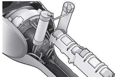
1. Preden baterijo odstranite, jo izpraznite. **Med odstranjevanjem baterije sesalnik Ergorapido ne sme biti priključen v polnilno enoto.** Odvijte vijke. Previdno dvignite pokrov.
