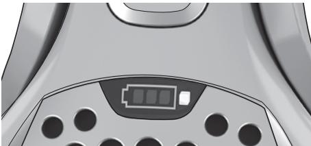
**2. Горит красный индикатор.** Блок перегрет. Очистите фильтры, щетку-ролик и шланг и начните зарядку.
