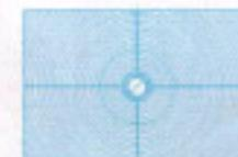
**Type P:** Dépoli à anneaux de Fresnel, avec stigmomètre à  $45^\circ$  dans un cercle central de  $\phi 3\text{mm}$ , entouré d'une couronne de microprismes de  $1\text{mm}$  de large. Un cercle concentrique  $\phi 2\text{mm}$  délimite la zone de prédominance d'analyse de la lumière. Un réticule facilite un cadrage précis et rapide. Convient à la photographie en général.
