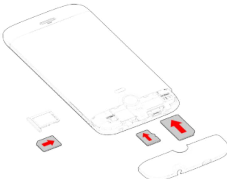
Inserire correttamente la scheda SIM standard nell'alloggiamento a sinistra.
