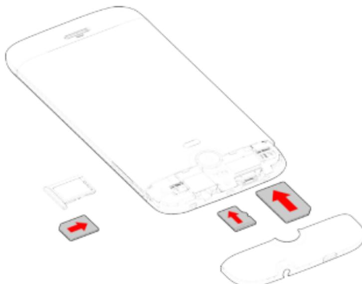
Sie die Standard-SIM-Karte korrekt in die linke Aussparung ein.
