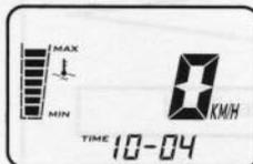
Indique l'heure réelle. Pour mettre l'horloge à l'heure, utilisez le bouton de **MODE**, l'enfoncer en maintenant la pression : l'horloge aura 10 incréments lents, puis l'incrément deviendra rapide. Si le véhicule est hors tension, cette fonction se met automatiquement à zéro et doit être reprogrammée. Effectuez cette opération uniquement avec le véhicule à l'arrêt et la clé de contact sur .
