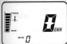
Indique la vitesse moyenne obtenue en km/h. Pour mettre cette fonction à zéro, enfoncez le bouton **MODE** et maintenir la pression, avec le véhicule à l'arrêt et la clé de contact sur
