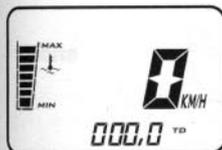
Indique la distance partielle en km et centaines de m. Pour mettre cette fonction à zéro, enfoncez le bouton **MODE** et maintenir la pression, avec le véhicule à l'arrêt et la clé de contact sur
