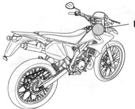
Le numéro d'identification du véhicule **I** est poinçonné sur le tube de direction.
