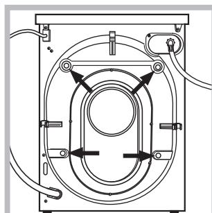
3. Enlevez les quatre vis de protection pour le transport, le caoutchouc et la cale, placés dans la partie arrière (voir figure).
