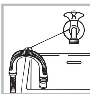
ou bien accrochez-le à un évier ou à une baignoire, dans ce cas, fixez le support en plastique fourni avec l'appareil au robinet (*voir figure*). L'extrémité libre du tuyau d'évacuation ne doit pas être plongée dans l'eau.
