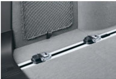
□ **Kit rangement** avec accoudoir central avant, des filets de rangement sur les dossiers des sièges avant, sur la console centrale côté passager et sur la gauche du compartiment à bagages, plancher réversible dans le compartiment à bagages, crochet multifonctions, sangle de fixation pour bouteille et glissières d'arrimage avec 4 œilletons verrouillables (photo).
