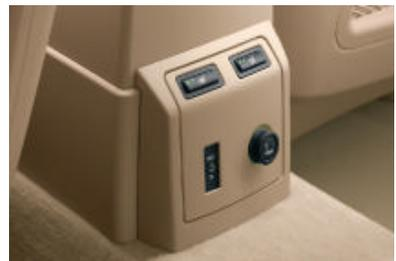
□ **Sièges arrière chauffants.** L'assise et le dossier des sièges droit et gauche sont chauffants.
