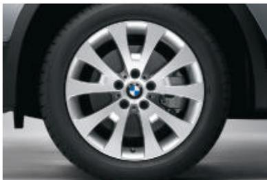
□ **Jantes en alliage léger\*\* 18" style 206 à rayons en V** avec monte pneumatique mixte. Dimensions : 8 J x 18 pouces à l'avant, pneumatiques 235/50 R 18 ; 9 J x 18 pouces à l'arrière, pneumatiques 255/45 R 18.
