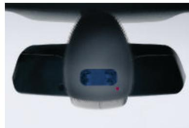
■ **Détecteur de pluie et allumage automatique des projecteurs**. Le détecteur de pluie enclenche les essuie-glaces dès les premières gouttes et commande la cadence du balayage en fonction de l'intensité de la pluie. L'allumage automatique des projecteurs actionne les feux de croisement dans un tunnel par exemple.
