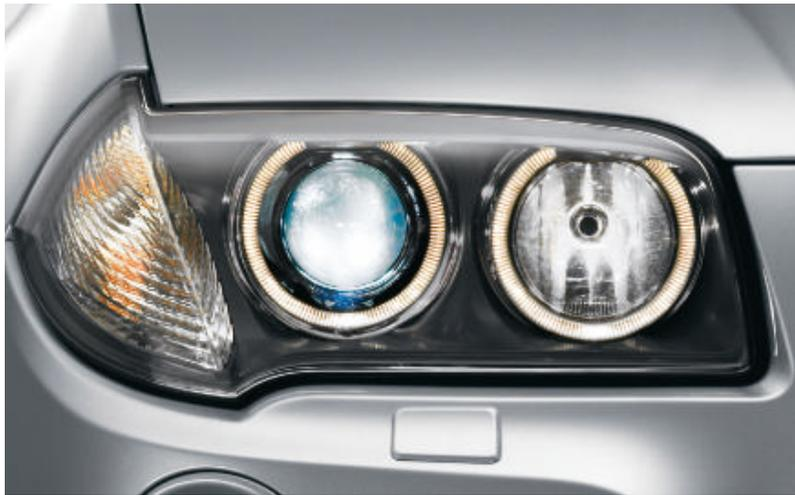
□ **Projecteurs bi-Xénon**, avec quatre anneaux lumineux pour fonction d'éclairage diurne et réglage automatique de la portée. Ils améliorent nettement l'éclairage de la chaussée la nuit ou par mauvaise visibilité.
