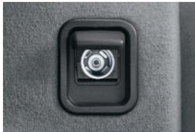
■ **Prise 12 V** intégrée au compartiment à bagages. Une deuxième prise 12 V se trouve sur la console centrale à l'arrière et une troisième à l'avant uniquement en combinaison avec le kit fumeurs de série.
