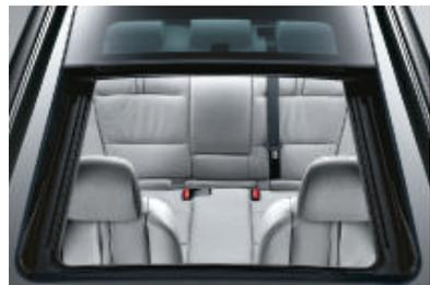
□ **Toit ouvrant panoramique en verre coulissant et entrebâillable électriquement** par simple pression sur une touche à impulsion, avec ouverture généreuse (0,65 m<sup>2</sup>), déflecteur d'air asservi à la vitesse, store pare-soleil de ciel de pavillon électrique, protection anti-pincement et ouverture/fermeture confort.
