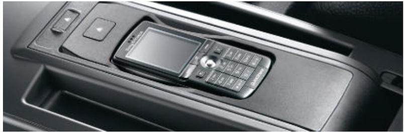
□ **Préparation pour téléphone Bluetooth** avec dispositif mains libres, connexion pour recharge et antenne. Un adaptateur (accessoire d'origine BMW) permet de raccorder un portable Bluetooth et de le commander via les touches multifonctions ou le système de navigation (option). Pour de plus amples informations sur les portables compatibles, veuillez vous adresser à votre Concessionnaire BMW.
