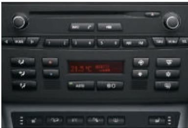
■ **Climatisation automatique** avec capteur d'ensoleillement et recyclage automatique de l'air AUC. Elle établit rapidement dans l'habitacle un confort thermique à la carte et maintient constante la température présélectionnée. La commande AUC ferme automatiquement l'entrée d'air frais dans l'habitacle à partir d'une certaine concentration de gaz nocifs.
