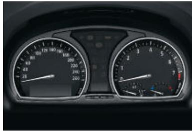
■ **Tableau de bord** à instruments analogiques et éclairage par transparence rouge, indicateur de vitesse avec affichage à cristaux liquides pour le totaliseur de distance parcourue, le totaliseur partiel et pour l'ordinateur de bord, compte-tours avec jauge de carburant et thermomètre pour le liquide de refroidissement intégrés.
