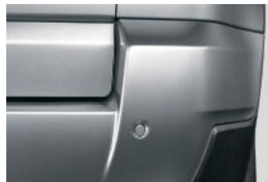
□ **Système d'aide au stationnement PDC avant et arrière.** Il facilite les manœuvres de stationnement sur les emplacements les plus étroits, la distance entre votre véhicule et un obstacle étant indiquée par un signal sonore.
