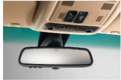
□ **Rétroviseur intérieur** avec boussole numérique (intégrée à droite, dans le miroir ; points cardinaux uniquement en anglais. Représentée ici avec l'option Télécommande universelle intégrée).
