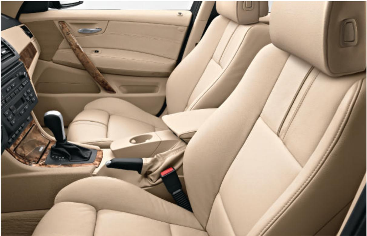
□ **Sièges avant Sport.** Les flancs de siège enveloppants assurent un maintien latéral optimal dans chaque situation de conduite ; réglages individuels de la hauteur de l'assise, de l'inclinaison du dossier et de l'assise, de la longueur de l'assise et de la position longitudinale du siège.
