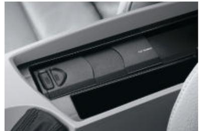
□ **Changeur de CD,** compatible MP3, intégré sous l'accoudoir, avec un espace de rangement pour trois CD. Le changeur peut abriter jusqu'à six CD.
