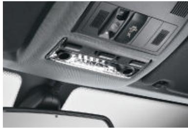
■ **Plafonnier à temporisation automatique** avec mise en marche et arrêt en douceur lors de l'ouverture ou de la fermeture des portes et éclairage d'ambiance de la console centrale ; avec en plus pour les BMW X3 xDrive30i, xDrive30d et xDrive35d, des liseuses à l'avant et à l'arrière, et l'éclairage du bas de l'habitacle à l'avant.
