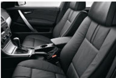
□ **Sièges avant Confort,** avec poches aumônières, réglage électrique de la hauteur de l'assise, du dossier, de la position longitudinale ainsi que de l'inclinaison de l'assise. Avec mémoires pour le siège conducteur et les rétroviseurs extérieurs (basculement automatique au passage de la marche arrière). Autres réglages électriques : soutien variable aux épaules, appui-tête et soutien lombaire.
