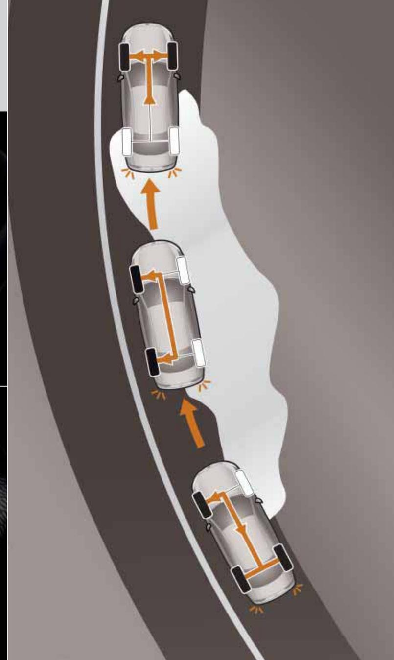
*Le Contrôle Electronique de Traction (TCS) n'affecte en rien la puissance de la voiture. Le système électronique de stabilité (ESP) contrôle les informations en provenance du volant, des pneus, des freins et de l'accélérateur en utilisant les données correspondantes pour effectuer les réglages nécessaires.*
