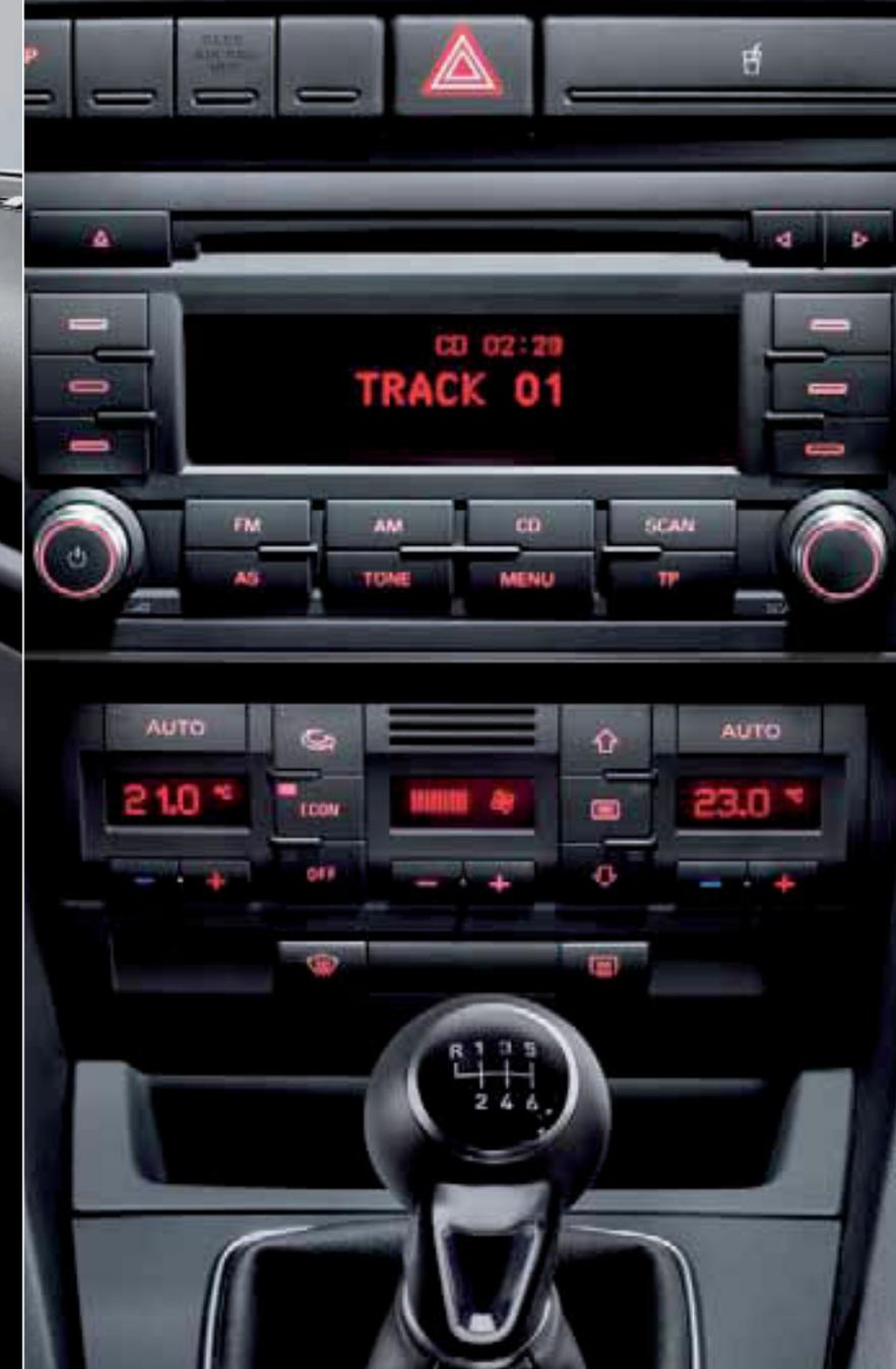
*Le système de climatisation Climatronic bizona régule les températures pour le conducteur et les passagers.*
