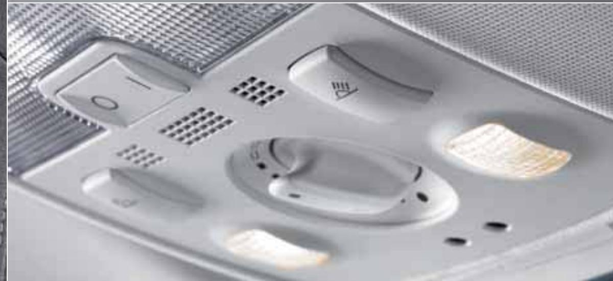
*Le toit ouvrant électrique solaire et les lampes de lecture avant sont facilement accessibles.*
