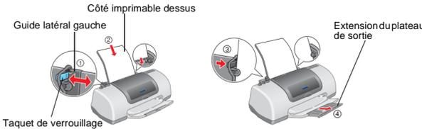
Pour régler le guide latéral gauche, enfoncez le taquet de verrouillage et faites coulisser le guide afin de l'appuyer contre la pile de papier.
