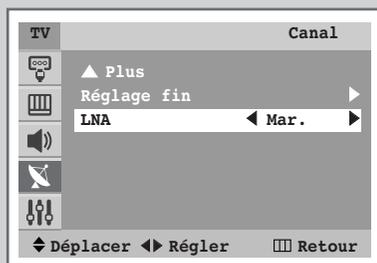
*Cette fonction est très utile lorsque le téléviseur fonctionne dans une zone où le signal est faible. Elle amplifie le signal du téléviseur, mais pas le bruit. Cette fonction ne s'applique que dans le cas d'un signal faible mémorisé sur le canal actuel.*
