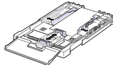
Si le papier sur lequel vous souhaitez imprimer est plus court que 222 mm (8,74 pouces), appuyez et déverrouillez le blocage de guide dans le bac et poussez le bac manuellement. Ajustez les guides de
