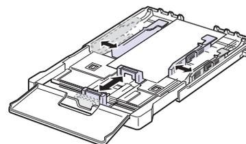
Si le papier sur lequel vous souhaitez imprimer est plus court que 222 mm (8,74 pouces), appuyez et déverrouillez le blocage de guide dans le bac et poussez le bac manuellement. Ajustez les guides de longueur et de largeur du papier.
