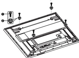
4 Insérez les 4 chevilles de l'écran à plasma dans les logements correspondants du support pour montage mural et tirez l'écran vers le bas (1) pour le fixer sur le support (2). Serrez les vis comme le montre la figure (3) de manière à ce que l'écran à plasma ne puisse pas être retiré du support de montage mural.
