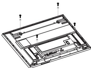
2 Utilisez les vis pour assembler le dispositif de fixation en plastique.
