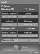
Appuyez sur la touche ▲ ou ▼ pour régler la minuterie de mise en veille à "-- (off), 30 min, 60 min, 90 min, 120 min, 150 min ou 180 min", puis appuyez sur ENTER.
