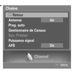
Appuyez sur le bouton ▲ ou ▼ pour sélectionner "Puissance signal", puis appuyez sur le bouton ENTER.
