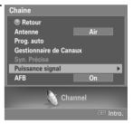
Si l'indicateur de puissance indique que le signal numérique est faible, déplacez votre antenne de manière à augmenter la puissance du signal. Continuez à régler l'antenne jusqu'à obtenir un signal maximum.
