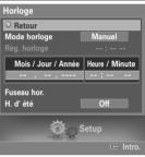
Appuyez sur le bouton ▲ ou ▼ pour sélectionner "Mode horloge", puis appuyez sur le bouton ENTER.
