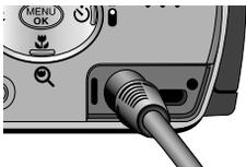
Si vous avez accès à une prise de courant, l'utilisation de l'adaptateur AC permet de faire usage de l'appareil photo durant de longues périodes. Branchez l'adaptateur au point de connexion (DC 5V IN) de l'appareil photo.
