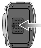
2. Insérez complètement la carte mémoire dans l'emplacement prévu pour la carte mémoire. L'étiquette sur la carte mémoire et la face avant de l'appareil doivent être tournées dans le même sens. Orientez les broches de la carte et l'écran à cristaux liquides (LCD) dans la même direction.
