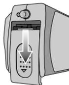
1. Ouvrez le logement des piles en faisant pression dans le sens de la flèche.
