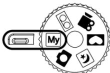
Ce mode permet aux utilisateurs d'enregistrer les paramètres de prises de vue fréquemment utilisés pour une utilisation ultérieure.
