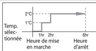
**Chauffage** La température diminue de 1°C par heure. Après une diminution de 2°C, la température est maintenue pendant 4 heures.
