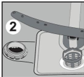
l'adoucisseur, enlevez d'abord le panier inférieur, puis dévissez le bouchon en le tournant dans le sens inverse des aiguilles d'une montre. 1 et 2
