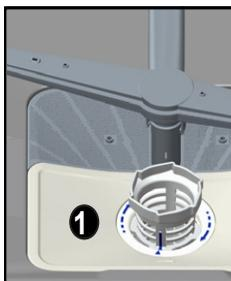
Pour extraire et nettoyer le groupe filtrant, tournez-le dans le sens inverse des aiguilles d'une montre et retirez-le en le soulevant. **1**
