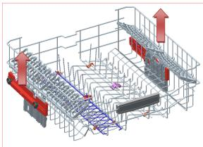
Le mécanisme de réglage de la hauteur du panier supérieur de votre machine a été conçu pour vous donner la possibilité d'ajuster la hauteur de ce panier supérieur vers le haut ou vers le bas, sans l'enlever de la machine lorsqu'il est plein. Cela permet de créer des espaces plus grands ou plus petits entre les paniers supérieur et inférieur. Le panier de votre machine a été réglé sur la position supérieure en réglage d'usine.
