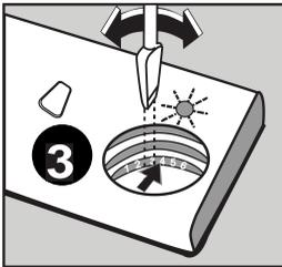
On peut régler le doseur de produit de rinçage de 1 à 6. Le doseur est réglé à la position 3 en usine.
