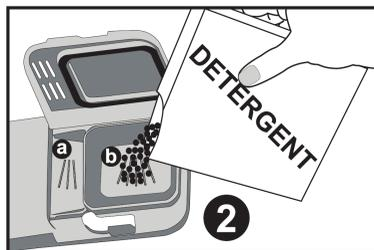
jusqu'à 40 cm<sup>3</sup> de détergent. Ouvrez l'emballage de détergent pour lave-vaisselle et versez dans le grand compartiment pré-lavage **b** 25 cm<sup>3</sup> de détergent. Si la vaisselle a été entreposée dans l'appareil
