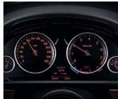
■ **Tableau de bord** avec 4 cadrans analogiques pour l'indicateur de vitesse, le compte-tours, le niveau de carburant et la température de l'huile moteur. L'écran d'information haute résolution de 5,7" (14,5 cm) situé en dessous affiche par ex. la consommation instantanée, les fonctions de l'ordinateur de bord et les indications du système de navigation s'il l'équipe le véhicule.
