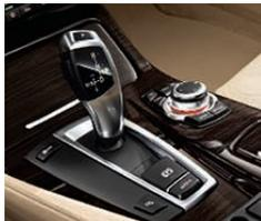
□ **Boîte automatique à 8 rapports avec Steptronic.** Avec sélection électronique des rapports et commande auto-adaptative. (De série sur BMW 550i, 550i xDrive et 535d)
