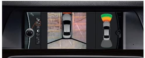
□ **Surround View** fournit des informations sur l'environnement direct du véhicule lors des manœuvres de stationnement. Avec ce système, la BMW est représentée sur l'écran de contrôle suivant une perspective à vol d'oiseau. La caméra de recul (option) et les caméras d'intersection offrent en outre une meilleure vue, respectivement lors des manœuvres de stationnement en marche arrière à moins de 20 km/h et aux intersections sans visibilité.
