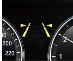
□ **L'avertisseur de franchissement de ligne** détecte grâce à une caméra tout rapprochement involontaire des lignes de délimitation de voies et avertit immédiatement le conducteur par des vibrations dans le volant.
