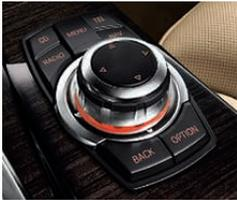
■ Le « **Controller** » est l'élément de commande central du système iDrive permettant de piloter toutes les fonctions de l'écran de contrôle. Avec touches d'accès direct pour les quatre menus CD, autoradio, navigation et téléphone fréquemment utilisés et huit touches de raccourci librement programmables auxquelles vous pouvez affecter les fonctions de votre choix.
