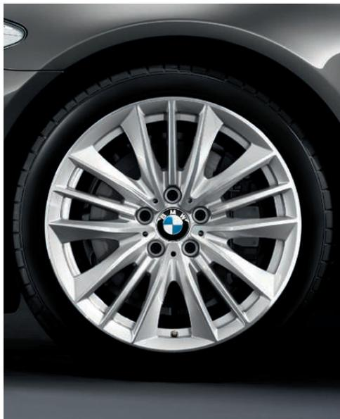
□ **Jantes en alliage léger 19" (48 cm) style 332 à rayons en W** avec monte pneumatique mixte RSC permettant le roulage à plat, 8,5 J x 19, pneumatiques 245/40 R 19 à l'avant; 9 J x 19, pneumatiques 275/35 R 19 à l'arrière.
