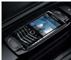
□ **Préparation BMW ConnectedDrive et interface Bluetooth pour téléphone portable<sup>1</sup>** (y compris dispositif mains libres). En combinaison avec un système de navigation, e-mails, calendrier ou SMS s'affichent à l'écran ou peuvent aussi être restitués en mode vocal via les haut-parleurs. (De série sur BMW 550i et 550i xDrive).
