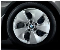
□ **Jantes en alliage léger 17" (43 cm) style 363 Aero** avec pneumatiques RSC permettant le roulage à plat, 8 J x 17, pneumatiques 225/55 R 17.
