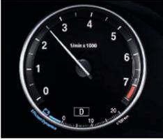
■ **Affichage BMW EfficientDynamics** : dans les phases de décélération, autrement dit dès que le conducteur relâche l'accélérateur, le système de récupération de l'énergie au freinage transforme l'énergie cinétique de la voiture en énergie électrique et la stocke dans la batterie. Le chargement de cette dernière est signalé par un symbole sur le compte-tours.
