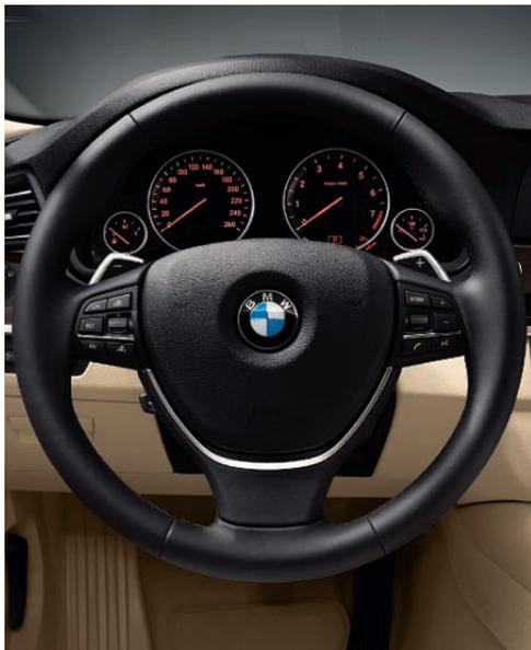
□ Le **volant Sport gainé cuir\*** avec touches multifonctions permet une maîtrise parfaite du véhicule. Les touches intégrées permettent de commander confortablement et en toute sécurité les fonctions audio, vocales et de téléphonie ainsi que le régulateur de vitesse (de série sur BMW 550i et 550i xDrive).
