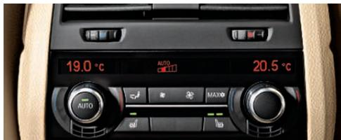
□ **Climatisation automatique à 4 zones**. Équipement similaire à la climatisation automatique bi-zone à fonctionnalités étendues avec, en plus, des aérateurs dans les montants centraux et des aérateurs confort au centre de la planche de bord pour une ventilation ciblée ou sans courant d'air. De plus, la température est réglable individuellement à l'arrière grâce à un élément de commande spécifique avec afficheur (de série sur BMW 550i et 550i xDrive).
