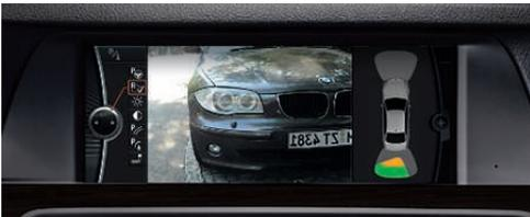
□ **La caméra de recul** filme l'espace derrière le véhicule, les images apparaissant sur l'écran de contrôle. L'affichage de trajectoires virtuelles vous montre par exemple si une place de parking est assez grande pour votre voiture. La caméra de recul s'active automatiquement au passage de la marche arrière.
