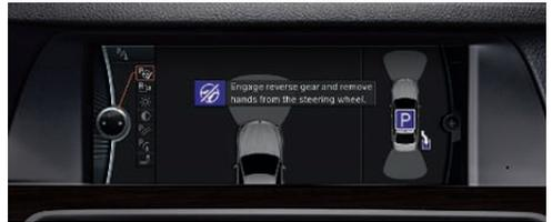
□ **Le système d'aide au stationnement intelligent « Park Assist »** facilite les manœuvres de stationnement en parallèle en mesurant l'écart entre deux voitures à une vitesse inférieure à 35 km/h. Lorsqu'une place suffisamment grande a été repérée, le système prend en charge les manœuvres de braquage et de contre-braquage tandis que le conducteur agit sur les pédales d'accélérateur et de frein. Le capteur est harmonieusement intégré dans le répétiteur de clignotant.
