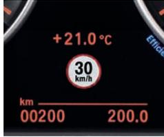
□ **L'indicateur de limitation de vitesse** détecte les panneaux de signalisation et indique au conducteur une notification et indique au conducteur entre autres la vitesse maximale autorisée sur l'écran d'information ou sur l'affichage tête haute HUD optionnel (uniquement en combinaison avec le système de navigation Professional).
