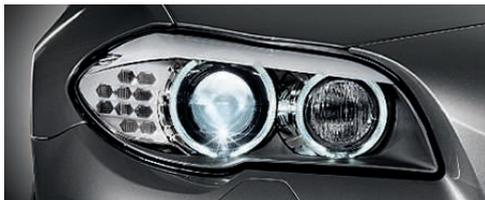
□ **Projecteurs bi-Xénon<sup>1</sup>** avec réglage automatique de la portée et lave-projecteurs. Améliorent nettement l'éclairage de la chaussée la nuit ou lorsque la visibilité est mauvaise. Les quatre anneaux lumineux à DEL avec fonction d'éclairage diurne peuvent également faire office de feux de stationnement.
