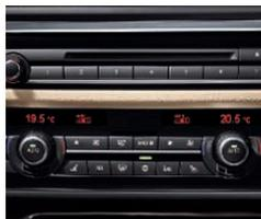
■ **Climatisation automatique bi-zone** : filtre pour air recyclé, capteur de buée, ventilation auxiliaire, exploitation de la chaleur résiduelle et régulation automatique de la température séparée à l'avant.
