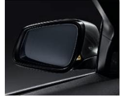
□ **L'avertisseur avancé d'angle mort** vérifie si un véhicule se trouve dans l'angle mort ou se rapproche rapidement sur la voie de dépassement lorsque le conducteur actionne le clignotant pour changer de file. Le cas échéant, le système l'alerte par des vibrations dans le volant et un signal optique sur le boîtier du rétroviseur extérieur.
