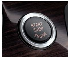
■ **Bouton de démarrage « Start/Stop ».** Il permet de démarrer ou d'arrêter le moteur après avoir déverrouillé le véhicule. La clé de contact est automatiquement reconnue sans avoir à l'insérer.
