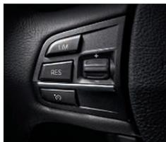
■ Le **régulateur de vitesse avec fonction freinage** permet d'enregistrer la vitesse souhaitée à partir de 30 km/h et la maintient constante.
