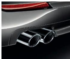
**Sorties d'échappement** : les modèles BMW 523i, 528i, 520d, 525d et 530d sont équipés d'une double sortie d'échappement apparente à gauche. Les BMW 535i et 535d sont dotées de deux sorties d'échappement simples à gauche et à droite.
