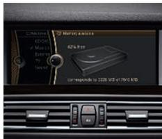
□ Le **disque dur de 12 Go** permet d'accéder rapidement à une collection complète de fichiers audio. Ces derniers peuvent être copiés à partir de CD, d'un lecteur MP3 ou d'une clé USB (composant du système de navigation Professional, de série sur BMW 550i et 550i xDrive).
