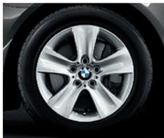
□ **Jantes en alliage léger 17" (43 cm) style 327 à rayons en étoile** avec pneumatiques RSC permettant le roulage à plat, 8 J x 17, pneumatiques 225/55 R 17.
