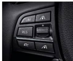
□ Le **régulateur de vitesse actif ACC+ avec fonction iBrake** et avertisseur de risque de télescopage est spécialement conçu pour faciliter la circulation en trafic dense. Il combine les fonctions de régulateur de vitesse – avec maintien actif d'une distance de sécurité par rapport au véhicule qui précède – et de freinage jusqu'à l'arrêt complet avec redémarrage automatique.
