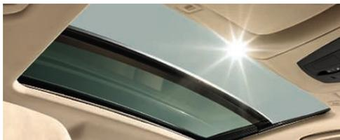
□ **Toit ouvrant** en verre coulissant et entrebâillable électriquement par touches à impulsions, store pare-soleil de ciel de pavillon à commande électrique, protection anti-pincement et ouverture/fermeture confort.
