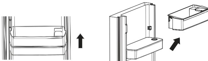
2. Démontez le réservoir d'eau. Détachez la couverture en haut et nettoyez le réservoir et la couverture.
