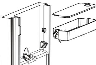
3. Après le nettoyage, remontez le réservoir d'eau, couvrez le compartiment du réservoir comme ci-dessous.
