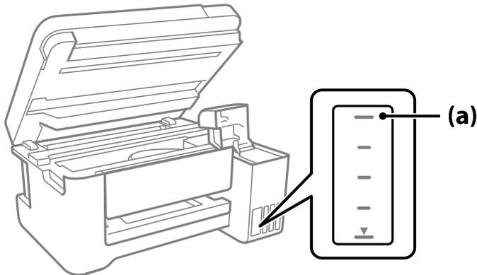
10. Alignez le sommet du flacon avec la goutte de remplissage, puis insérez-le dans celle-ci pour remplir l'encre jusqu'à ce qu'elle atteigne la ligne supérieure et que l'écoulement s'arrête automatiquement.
