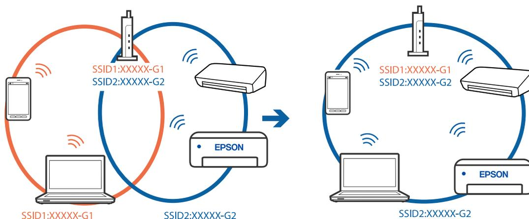
❑ Exemple de connexion à des SSID de différentes plages de fréquences
