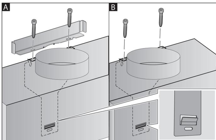
5. Si aucune gaine n'est montée, vissez deux vis de sécurité sans angle. **B**
