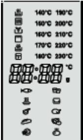
La fenêtre d'affichage indique le mode de cuisson, la température de cuisson en mode chaleur à convection et en mode cuisson automatique.
