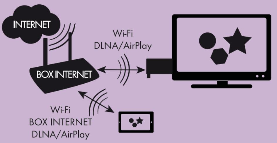
Ce mode ne permet pas de faire du miroir avec un téléphone Android, ce mode doit être utilisé avec les iPhones, iPads ainsi que les autres appareils capable de gérer le protocole DLNA.
