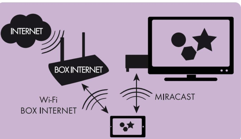
Ce mode permet uniquement de faire du miroir avec un appareil Android. Votre smartphone/tablette doit disposer de la fonctionnalité Miracast. La connexion Wi-Fi de votre smartphone/tablette restera connectée sur le réseau Wi-Fi de votre box Internet et il n'est pas nécessaire que le MyMirror3 soit connecté à Internet.
