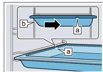
3. Pour installer les accessoires à hauteur d'encastrement avec les rails télescopiques, sortez ces derniers.
