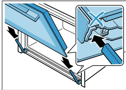
**2. Appuyez sur le recouvrement de la porte avec les deux mains en haut à gauche et à droite pour vérifier si la porte de l'appareil est bien enfoncée jusqu'en butée.**
