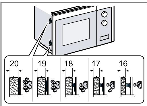
3. Das Gerät so lange festschrauben, bis das Gerät mittig ausgerichtet ist.
