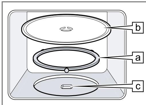
2. Engager le plateau tournant **b** dans l'entraînement **c** au centre du fond du compartiment de cuisson.
