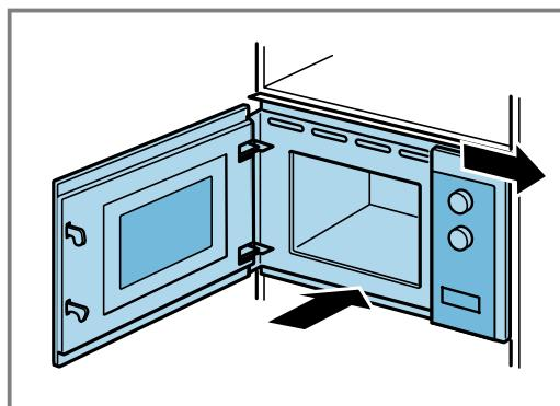
3. Het apparaat zo lang vastschroeven tot het apparaat in het midden is uitgelijnd.
