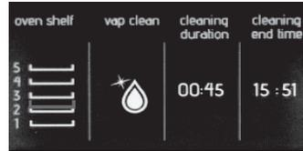
Dans l'écran de sélection de fonction, appuyez sur le bouton de droite pour sélectionner la fonction VapClean.
