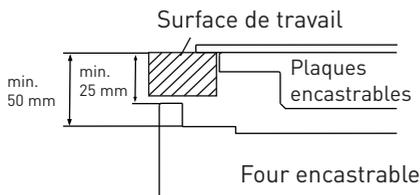
Si le four est installé sous une plaque de cuisson, la distance entre la surface de travail et le panneau supérieur du four doit être d'au moins 50 mm et la distance entre la surface de travail et la surface supérieure du panneau de contrôle doit être d'au moins 25 mm.
