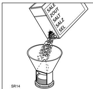
4. A l'aide de l'entonnoir livré avec l'appareil, remplissez le réservoir de sel.
