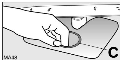
7. Remplacez le filtre plat (C) en vérifiant que les bords du filtre s'applique correctement sur le fond de la cuve.
