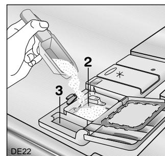
3. Tous les programmes avec pré-lavage nécessitent une petite quantité de détergent supplémentaire (5/10 g) à placer dans le compartiment (3) du réservoir.
