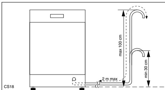
De même, les raccords utilisés pour le branchement doivent avoir un diamètre intérieur non inférieur à celui du tuyau d'évacuation.
