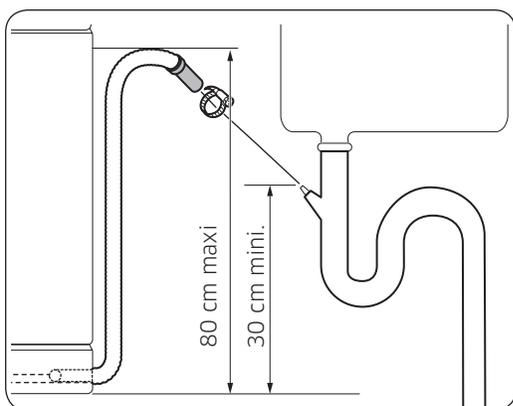
4. Connectez le tuyau d'évacuation à l'orifice de vidange.
