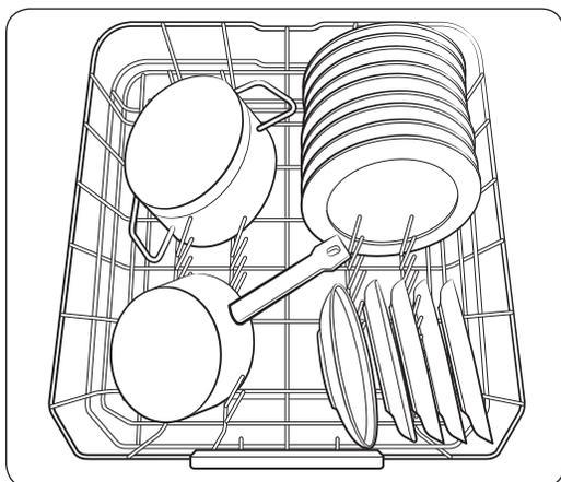
Pour un nettoyage plus efficace, chargez les éléments volumineux dans la zone de gauche du panier inférieur– espaces Zone Booster+. La fonction Zone Booster+ active des jets d'eau plus puissants dans les espaces Zone Booster+. Assurez-vous que les poignées des casseroles ou des poêles n'empêchent pas la rotation des gicleurs et du réflecteur d'eau.
