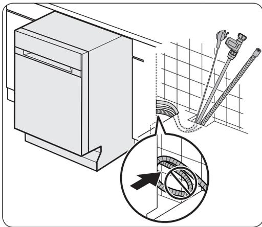
1. Disposez la fiche électrique, le tuyau d'eau et le tuyau d'évacuation.
