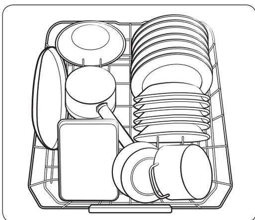
Placez la batterie de cuisine (casserole, poêle, etc.) d'un diamètre maximal de 31 cm dans le panier inférieur. Le panier inférieur a été spécialement conçu pour accueillir la vaisselle de table, les bols, les assiettes, les plats, les couvercles et les casseroles.
