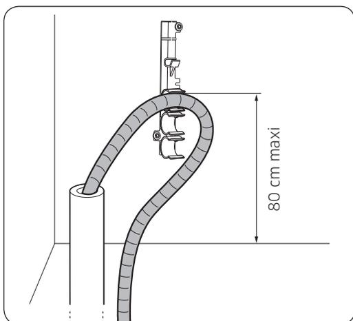
3. Insérez le tuyau d'évacuation dans le porte-tuyau de sorte que le tuyau d'évacuation soit placé entre 30 et 80 cm de la partie inférieure.
