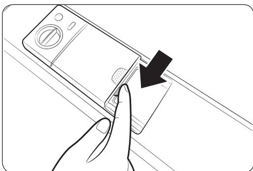
1. Appuyez délicatement sur le couvercle du réservoir de produit de lavage pour le déverrouiller, ouvrez-le en le faisant glisser. Notez que le couvercle du réservoir de produit de lavage s'ouvre à la fin de chaque cycle.
