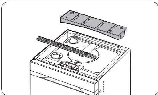
4. Si nécessaire, retirez la partie en plastique et le contrepoids à l'arrière. Pour ce faire, retirez les vis indiquées sur la figure ci-contre.
