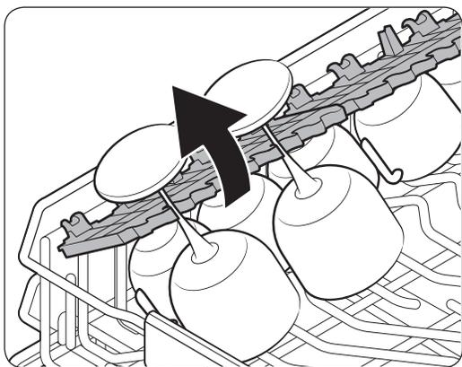
Le porte-verres est spécialement conçu pour les verres à pied. Glissez les verres à pied dans les encoches du porte-verres prévues à cet effet. Repliez le porte-verres si vous ne souhaitez pas vous en servir au cours d'un lavage.
