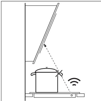
**i** Otros aparatos controlados a distancia pueden bloquear la señal. No utilice ningún otro aparato cerca de la placa mientras esté Hob<sup>2</sup>Hood activado.
