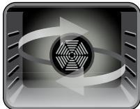
El indicador del termostato y las luces de advertencia del horno se encienden, las resistencias circular e inferior comienzan a calentar y el ventilador comienza a funcionar. Esta función es ideal para hornear alimentos, como pizzas, de manera uniforme y en poco tiempo. El ventilador distribuye de forma homogénea el calor del horno, mientras que el elemento calefactor inferior se encarga de hornear los alimentos.
