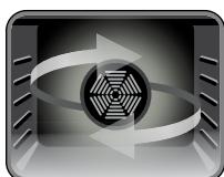
Het thermostaatlampje en de waarschuwingslampjes van de oven gaan branden. De ronde en onderste weerstand en de ventilator treden in werking. De Pizzafunctie is ideaal voor het gelijkmatig bakken van voedsel, zoals pizza, op korte tijd. Terwijl de ventilator de hitte in de oven gelijkmatig verdeelt, zorgt de onderste weerstand dat het gerecht wordt gebakken.
