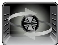
Le voyant du thermostat et les voyants d'avertissement du four s'allument, les résistance circulaire et inférieure commencent à chauffer et le ventilateur se met à tourner. La fonction Pizza convient à la cuisson uniforme d'aliments comme les pizzas sur un court laps de temps. Le ventilateur répartit uniformément la chaleur dans le four, tandis que la résistance inférieure cuit les aliments.
