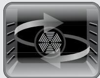
Le voyant du thermostat et les voyants d'avertissement du four s'allument, les résistances supérieure et inférieure commencent à chauffer et le ventilateur se met à tourner. Cette fonction convient à la cuisson de pâtisseries. La cuisson s'effectue grâce aux résistances inférieure et supérieure du four ainsi qu'au ventilateur brassant l'air, ce qui donne aux aliments un aspect légèrement « grillé ». Il est recommandé de préchauffer le four pendant environ 10 minutes.
