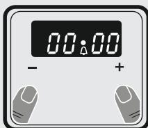
Het tijdstip van het geluidssignaal kan worden ingesteld op een tijdsperiode tussen '0:00' en '23:59' uur. De tijd van het geluidssignaal is alleen bedoeld voor waarschuwingsdoeleinden. De oven zal bij deze functie niet worden ingeschakeld.
