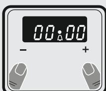
L'alarme sonore peut être réglée entre **0:00** et **23:59**. L'alarme sonore existe à des fins d'alerte uniquement, et n'active pas le four.
