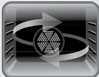
El indicador del termostato y las luces de advertencia del horno se encienden, las resistencias superior e inferior comienzan a calentar y el ventilador comienza a funcionar. Esta función es buena para hornear pastelitos. La cocción se lleva a cabo mediante los elementos calefactores inferior y superior que hay en el interior del horno y mediante el ventilador, que distribuye el aire, dando un ligero toque grill a la comida. Se recomienda precalentar el horno durante unos 10 minutos.
