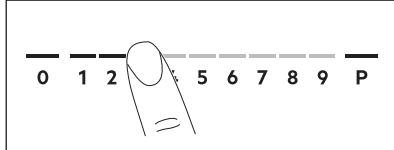
Als u eenmaal een pan op de zone zet en de kookstand instelt, blijft deze gedurende 2 minuten gelijk nadat u de pan heeft verwijderd. De regelbalk en de aanduiding van de kookzone knipperen gedurende 2 minuten. Als u de pan binnen deze tijd weer op de kookzone plaatst reageert de kookstand. Zo niet, wordt de kookzone gedeactiveerd.
