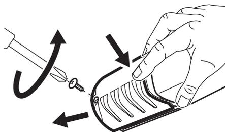
3. Remplacez la lampe par un éclairage de caractéristiques et de puissance similaires.
