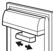
Ce modèle est doté d'un balconnet de porte coulissant intégré en dessous d'un bac à fromages et peut être coulissé latéralement.
