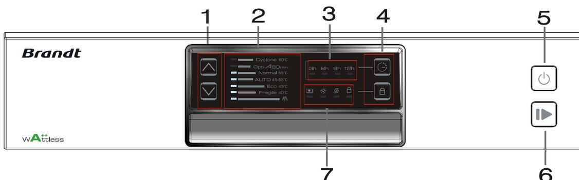
1. Touche de sélection de programme: Appuyez sur le touche pour sélectionner un programme de lavage . Appuyez sur les deux touches simultanément pendant 3 secondes pour sélectionner la fonction "Tout en un". Appuyez à nouveau pour l'annuler.
