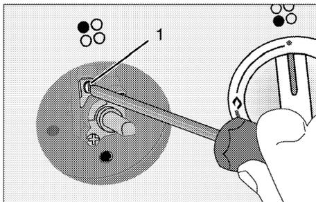
5. Réglez la hauteur de la flamme sur 2 à 3 mm à l'aide de la vis 7 sur le thermostat du four. Tourner la vis dans le sens des aiguilles d'une montre réduit la flamme, dans le sens inverse des aiguilles d'une montre augmente la flamme.
