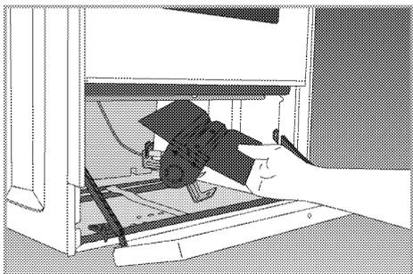
5. Dévissez l'injecteur en tournant dans le sens contraire des aiguilles d'une montre.
