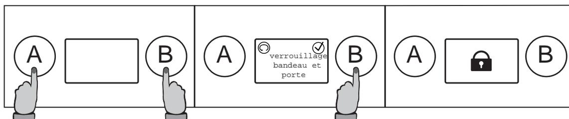
Pour désactiver la sécurité, appuyez simultanément sur les manettes **A** et **B** durant quelques secondes.
