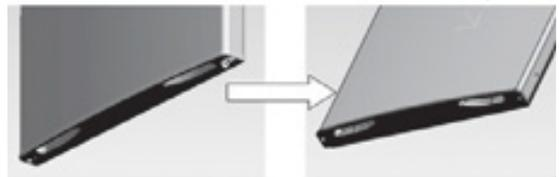
C. À l'aide d'un tournevis, retirez l'autre bloc de butée fixé à la porte.
