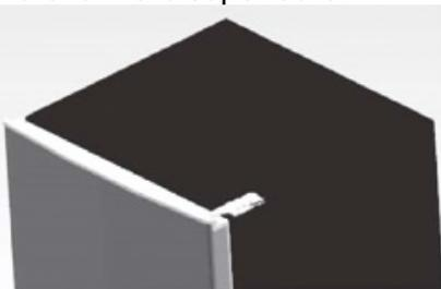
3) Remplacez la charnière supérieure et le bloc de butée de la porte supérieure, puis le coussinet de la porte de l'autre côté.
