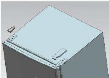
2) À l'aide d'un tournevis cruciforme, retirez les vis fixant la charnière supérieure.
