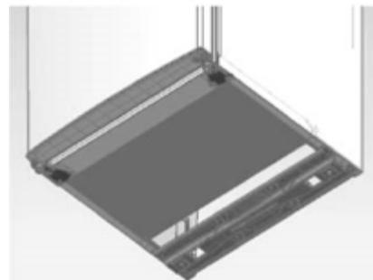
Remarque : L'angle d'inclinaison du réfrigérateur est inférieur à 45°.
