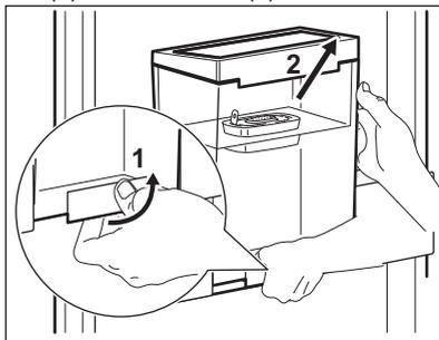
2. Ouvrez le couvercle avec vos doigts (1). Puis débloquez les 2 éléments d'arrêt de l'autre côté du cache (2).
