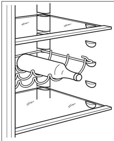
2. Cette clayette peut être inclinée afin d'y placer des bouteilles déjà ouvertes. Pour ce faire, placez les crochets à l'avant de la clayette un niveau plus haut que les crochets à l'arrière.
