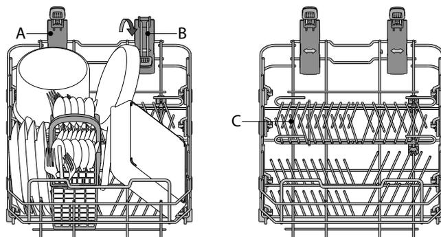
Le panier inférieur comprend des supports rabattables **C** qui peuvent être placés en position verticale pour charger des plaques, ou en position horizontale (bas) pour faciliter le chargement des casseroles et des bols de salade.
