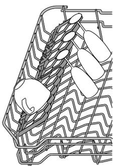
Les volets pliables latéraux peuvent être pliés ou dépliés afin d'optimiser la disposition de la vaisselle à l'intérieur du rack.
