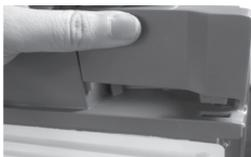
23. Insérez le volet de protection des câbles sur la partie supérieure de la porte du réfrigérateur, puis poussez-le pour l'assembler complètement.
