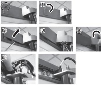
4. Débranchez le connecteur du câblage de la porte du réfrigérateur. (Sur les modèles avec affichage externe uniquement)
