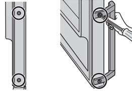
2. Insérez les vis d'assemblage de la poignée (x2) dans chaque trou de la poignée, des deux côtés.
