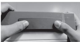
25. Détachez les joints du réfrigérateur et du congélateur, puis fixez-les après une rotation de 180 degrés.
