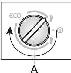
Si la température de la pièce dans laquelle l'appareil est installé est inférieure à 16°C, nous vous recommandons de régler le bouton **A** vers l'icône
