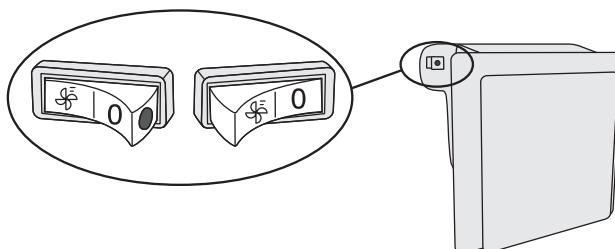
Lorsque le ventilateur est en marche, un point rouge est visible sur l'interrupteur.
