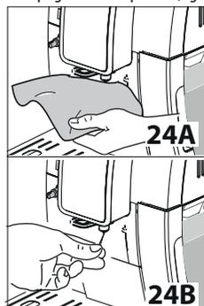
2. Controllare che i fori dell'erogatore caffè non siano otturati. Se necessario rimuovere i depositi di caffè con uno stuzzicadenti (fig. 24B).
