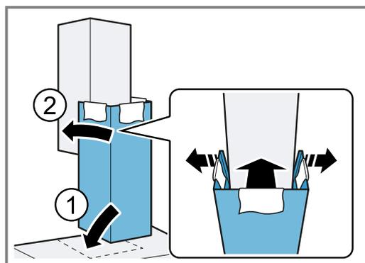
7. Clipser le capot de cheminée inférieur contre la cornière de retenue inférieure. Veiller à ce que le câble de raccordement ne soit pas coincé.
