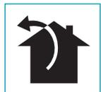
I denne versjonen blir røyk og damp ledet ut i det fri gjennom et avtrekksrør. Til dette formålet, må ventilatorhettens utløpskopling kobles med et rør til en ekstern utgang.
