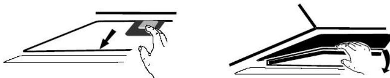
Positionnez le filtre à charbon actif dans le bloc et tournez-le dans le sens des aiguilles d'une montre. Faites pareil de l'autre côté.
