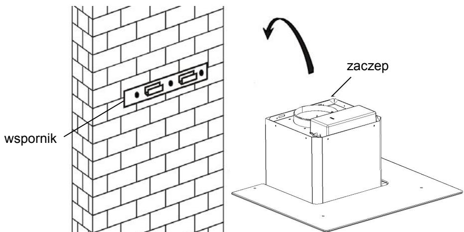
5. Zamocować zawór zwrotny na wylocie okapu a następnie założyć kanał wylotowy jak pokazano na rysunku.
