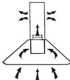
V tem primeru v napo vstavite filter z aktivnim oglem, ki zadrži vonjave. Najprej morate sneti filter za maščobe, nato pa lahko vstavite ogleni filter. Potisnite na zapah in potegnite filter za maščobe navzdol.
