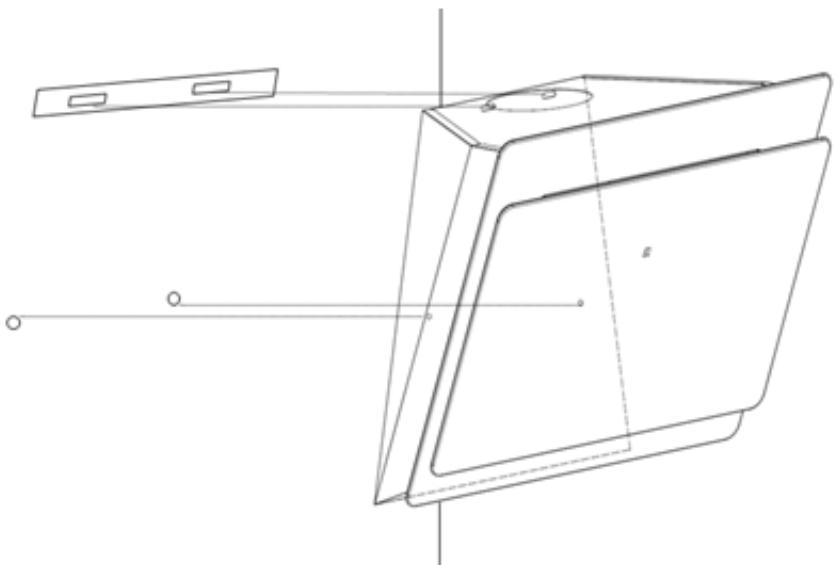
4. Levante e segure a chaminé e encaixe-a no suporte de parede depois deste ser colocado.
