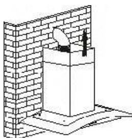
ii. Vysunutím krytu nastavte výšku odsavače. Po dosažení požadované výšky připevněte upevňovací otvor šrouby podle obrázku.
