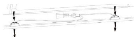
Odłączyć przewód elektryczny i wyjąć oprawki z przewodami z okapu.
