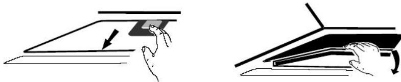
Legen Sie den Aktivkohlefilter in das Gerät und drehen Sie ihn im Uhrzeigersinn. Wiederholen Sie das gleiche auf der anderen Seite.
