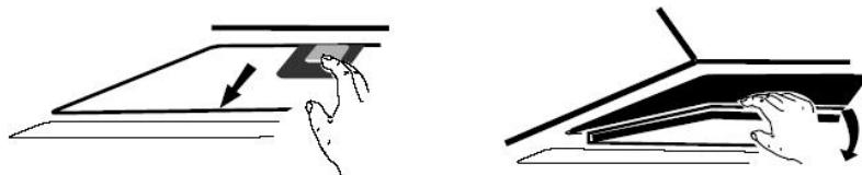
Namjestite aktivni ugljeni filter na motor nape i učvrstite ga okretanjem udesno.
