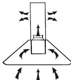
Pri unutarnjoj ventilaciji, za filtriranje dima i para koristi se aktivni ugljeni filter.
