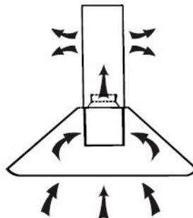
Puteti folosi filtru de carbon activ pentru evacuarea mirosurilor nedorite. Pentru a monta filtrul de carbon activ, trebuie mai întâi să scoateti filtrul pentru grăsimi. Apăsați mânerul și trageți-l în jos.
