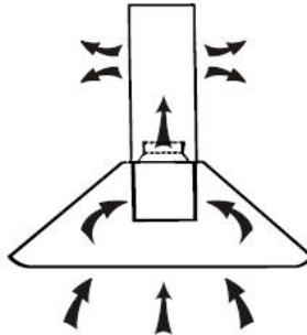
Aktivkohlefilter können eingesetzt werden um Gerüche aufzufangen. Um die Aktivkohlefilter zu installieren, sollten die Metallfettfilter zuerst gelöst werden. Drücken Sie die Verriegelung und ziehen ihn nach unten.
