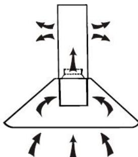
Μπορείτε να χρησιμοποιήσετε το φίλτρο ενεργού άνθρακα για να περιορίσετε τις μυρωδιές. Για να τοποθετήσετε το φίλτρο ενεργού άνθρακα πρέπει να αφαιρέσετε πρώτα το φίλτρο κατακράτησης λίπους πιέζοντας το γάντζο στερέωσης.
