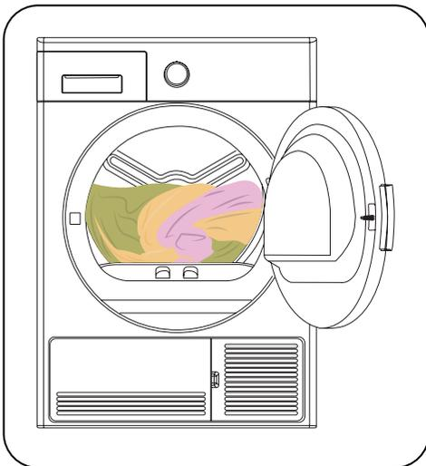
**IMPORTANT** : Il n'est pas recommandé de charger le sèche-linge avec une quantité de linge supérieure à celle indiquée sur la figure ci-dessus. Lorsqu'il est surchargé, sa performance de séchage diminue, ce qui peut causer des dommages au sèche-linge et au linge.
