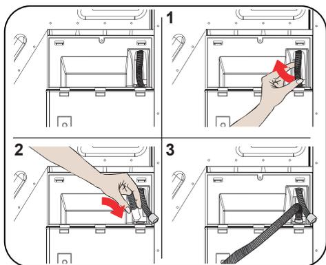
**⚠ ATTENTION** : Le tuyau doit être raccordé de manière à ne pas pouvoir être déplacé. Si le tuyau sort pendant l'évacuation de l'eau, il peut y avoir une inondation dans votre maison.
