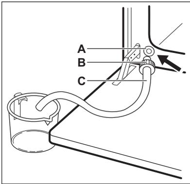
3. Ouvrez la porte du four puis insérez l'embout (B) dans la vanne de vidange (A).
