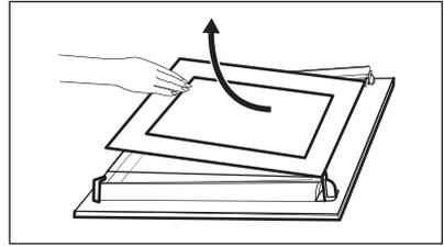
11. Nettoyez les panneaux de verre à l'eau savonneuse. Séchez soigneusement les panneaux de verre.
