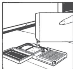
Le bac pour le produit lessiviel est situé à l'intérieur de la porte. Le couvercle du bac doit être refermé avant chaque lavage, pour l'ouvrir appuyer sur le clip. A la fin de chaque lavage le couvercle reste ouvert pour la prochaine utilisation.
