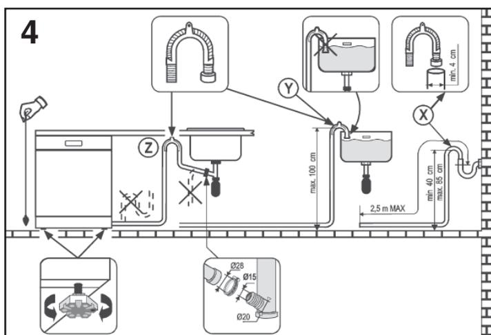
L'extrémité recourbée du tuyau de vidange peut être accrochée au bord d'un évier (l'extrémité ne doit pas être immergée dans l'eau, pour éviter le siphonnage de l'appareil pendant le programme de lavage).
